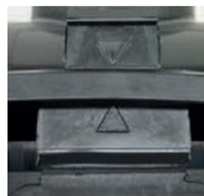
⑨ 9) Collegare la saldatrice agli spinotti del raccordo e, in caso di saldatrice manuale o polivalente, verificare la misura corretta degli spinotti. Procedere all'acquisizione dei parametri di saldatura secondo le istruzioni del manuale d'uso della saldatrice. A fine ciclo, verificare la fuoriuscita degli indicatori di fusione predisposti sul raccordo.
