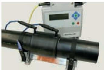
⦿ (J) Collegare la saldatrice ai terminali del raccordo e, in caso di saldatrice manuale o polivalente, verificare la misura corretta degli spinotti. Procedere all'acquisizione dei parametri di saldatura secondo le istruzioni del manuale d'uso della saldatrice. A fine ciclo, verificare la fuoriuscita degli indicatori di fusione predisposti sul raccordo.
