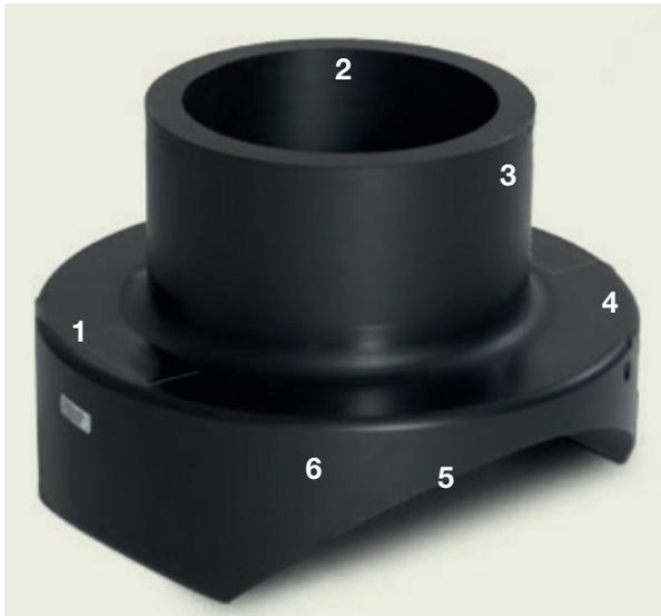
Il raschiatore, permette una costante rimozione dello strato di polietilene degradato, con la possibilità di essere regolato in modo continuo e generare un truciolo tale da poter eventualmente essere misurato per una richiesta di verifica dello spessore di raschiatura.
